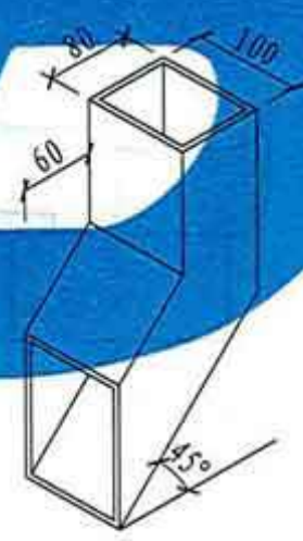
④ 外排镀锌钢板管底方(圆)出水口 注: 镀锌钢板0.6厚。
